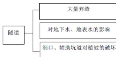
隧道施工对生态影响污染特性图
