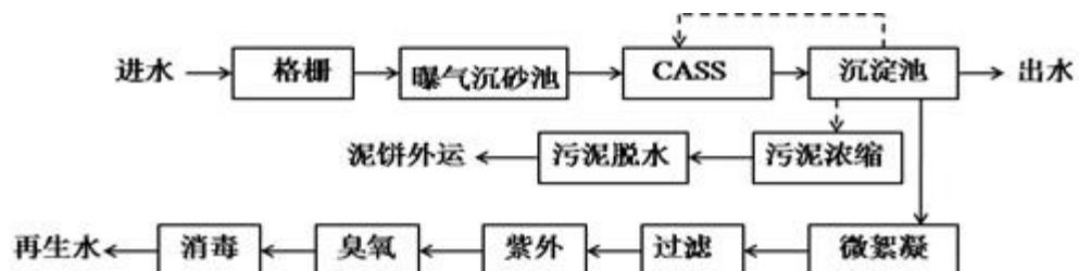
图 7-4-2 吴家村污水处理厂污水处理工艺流程图
