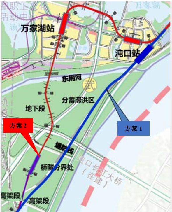
图 1.10-3 川江池站～沌口站线路及敷设方案比选示意图
