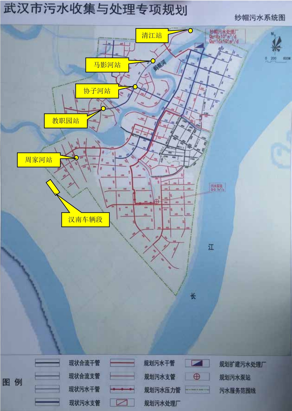
图 6.2-4 纱帽（汉南）污水系统图
