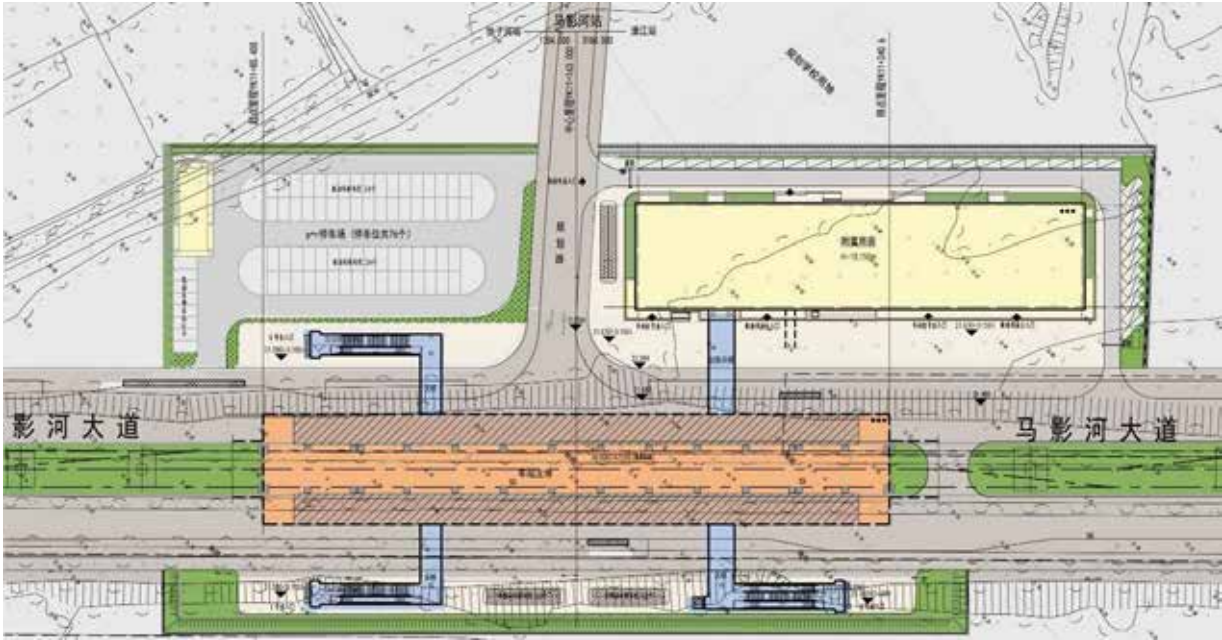
图 2.1-5 马影河站总平面布置图
