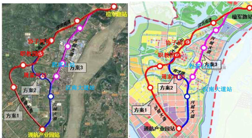
图 1.10-2 通航产业园站（远期延伸）～檀军路站线站位方案比选示意图
