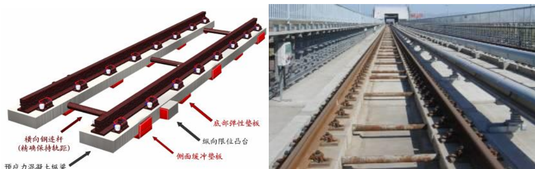
图 6.3-3 梯形轨枕(即纵梁式轨枕)的构成及实施照片
