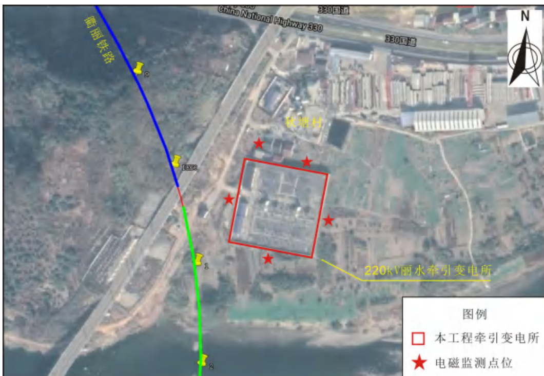
图 8.2-4 220kV 丽水牵引变电所周边环境及监测点位
